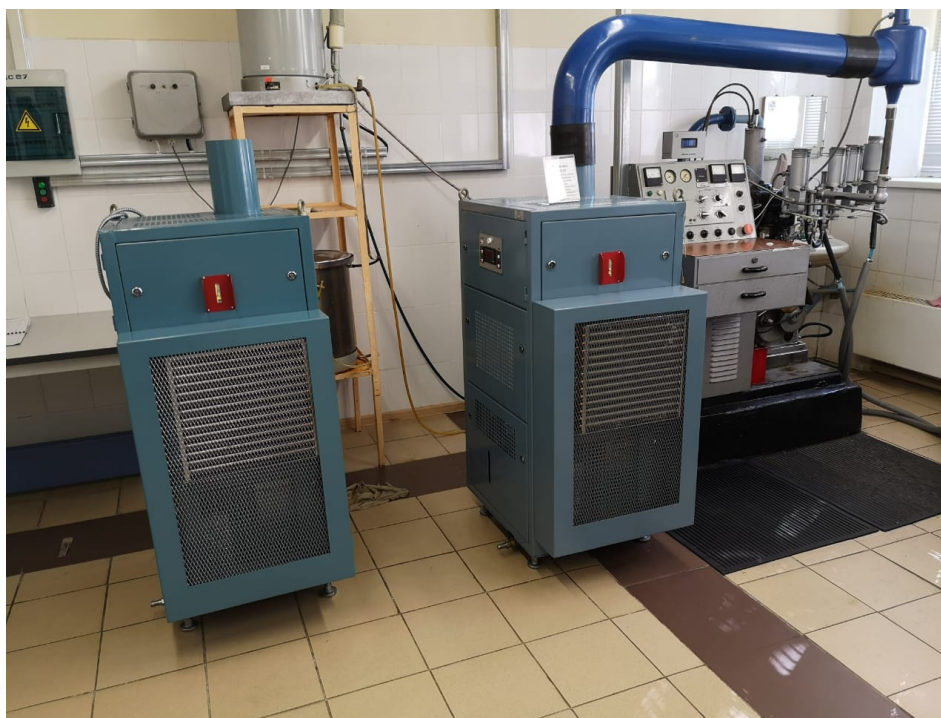
Модернизированная установка УИТ - 85 с установленным штатным карбюратором от установки УИТ - 85М и модернизированной станцией СОТ - 1.
