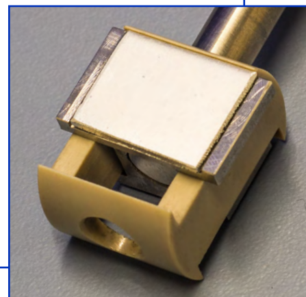
Магнитная система позиционирования твёрдых образцов
