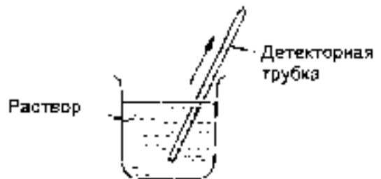
2. Метод погружения трубки
